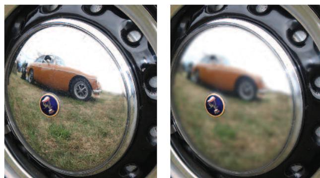
*La diffusion est un problème commun associé aux revêtements et aux matériaux polis. Les surfaces avec la diffusion ont une finition laiteuse avec une image réfléchie «superficielle». Cette caractéristique importante est mesurée directement grâce au Rhopoint IQ.*
