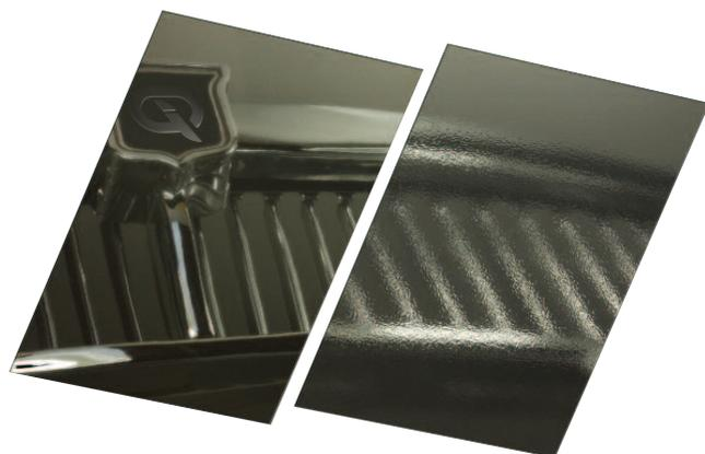
*L'effet de peau d'orange réduit considérablement la qualité de l'apparence sans affecter les lectures de brillance. Ces deux panels de tests sont mesurés de la même manière par un brillancemètre standard ; seul le Rhopoint IQ avec des mesures RIQ/DOI peut quantifier les différences.*
